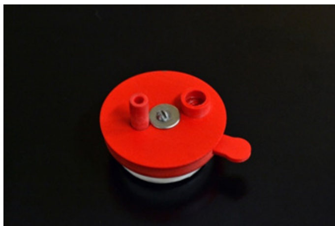
Imagen 4. Prototipo de la tapa mediante impresión 3D en ABS.
