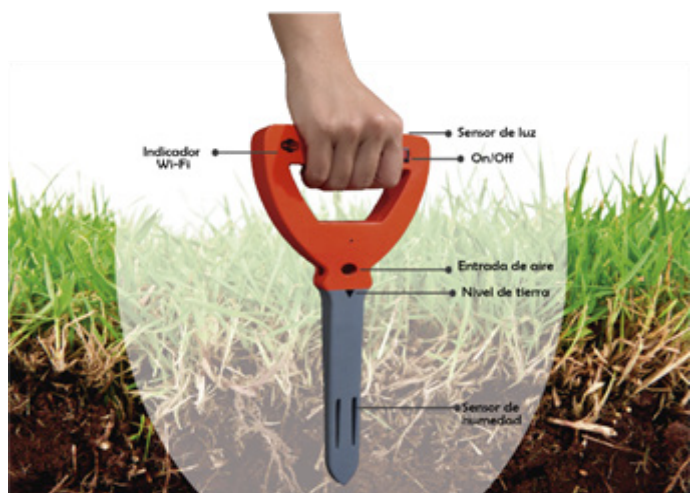
Figura 2. Modelo del sistema basado en IoT para el monitoreo de cultivos verticales
