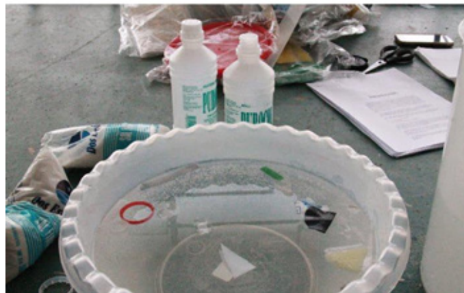
Pruebas de identificación y clasificación de plásticos.
