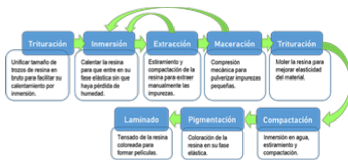
Fig.1. Esquema del procesamiento artesanal de la resina mopa mopa
