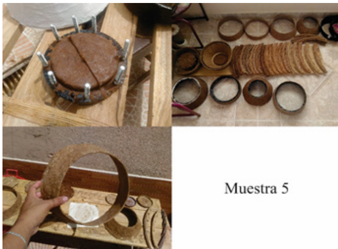
Figura 5 Formas elaboradas a partir del uso de moldes de fibra de vidrio
