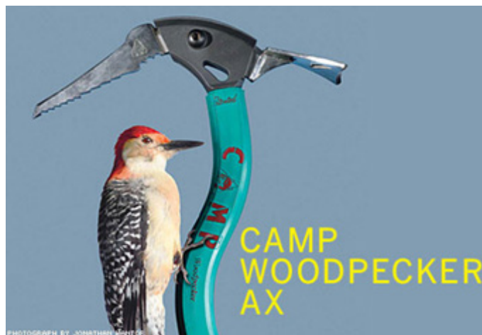
Imagen 1. Camp Woodpecker Ax, diseñador venezolano Franco Lodato. Focalizado en el pájaro carpintero como el mejor martillador natural, Lodato se centró en la parte inferior de la cabeza del martillo y añadió una ligera curva a la columna vertebral. El resultado fue una herramienta con mejor ángulo para su manipulación, más equilibrado, un golpe más eficiente, y un producto de superventas para la empresa de productos de montañismo CAMP”. (Fotografía por Jonathan Kantor)
